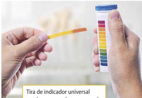
Tira de indicador universal sendo comparada com a escala padrão para medição do pH.
